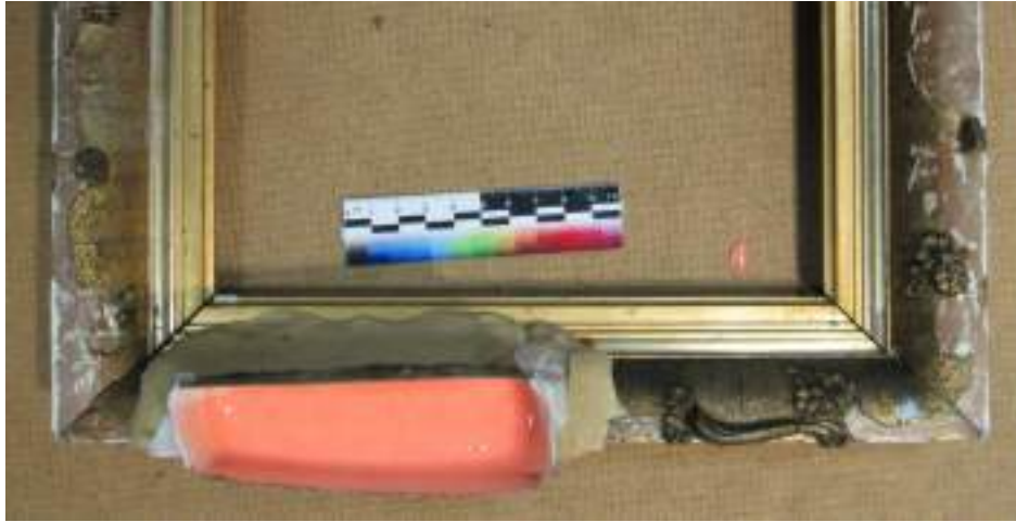
Илл. 8. Фрагмент нижнего листа рамы в процессе формовки
