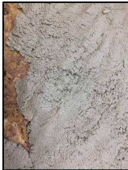
Илл. 16. Удаление стойких поверхностных загрязнений с фрагментов плиты при помощи компресса
