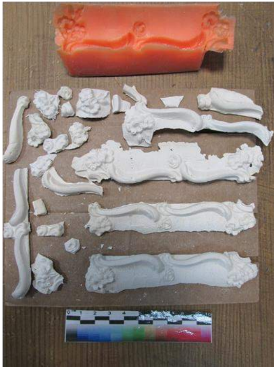
Илл. 9. Отливка гипсовых фрагментов в форме из «Компаунда»
