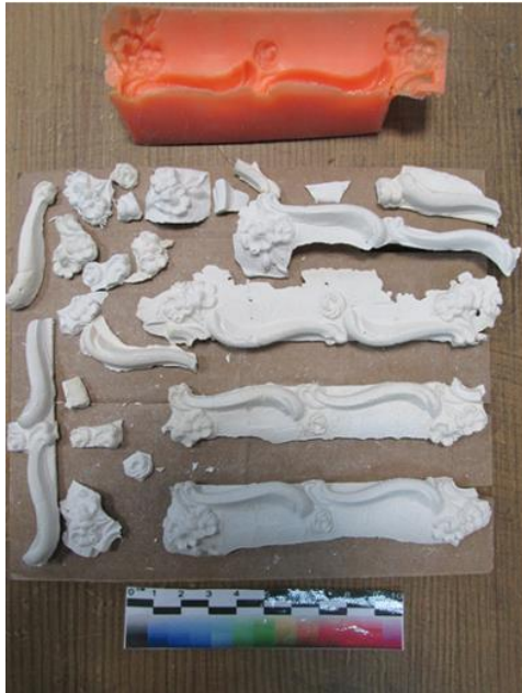
Рисунок 9. Отливка гипсовых фрагментов в форме из «Компаунда»
