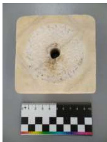
Илл. 15. Фрагмент памятника А.А. Горяйнову. Плинт-подставка под вазу-светильник. После склейки
